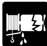
**5** Verifique desgastes DE **IMPORTANCIA** en el cable de acero, ajuste de los grilletes, funcionalidad del gancho de acoplamiento, desgaste del seguro del gancho y ceciórece que el guardacabo este bien posicionado
