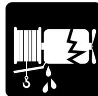
**5** Verifique desgastes DE **IMPORTANCIA** en el cable de acero, ajuste de los grilletes, funcionalidad del gancho de acoplamiento, desgaste del seguro del gancho y asegúrese que el guardacabo este bien posicionado
