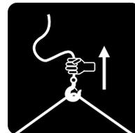
**5** Durante el izaje o descenso de carga evite el efecto de péndulo, realice las paradas necesarias para anular este movimiento
